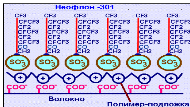
Рис.2. Схема модифицирующего слоя интерполимерного комплекса фторПАВ Неофлона-301 и катионного полимера на поверхности волокон текстильных материалов. Из приведенных на рис.3. данных следует, что модифицирующий слой и без химического закрепления на поверхности волокон способен выдержать несколько химических чисток без снижения эффективности ниже приемлемой. Это возможно в результате проникновения модификатора внутрь нанопор волокон и последующего выхода его на поверхность в результате диффузии и заживления дефектов модифицирующего слоя, возможных после десорбции части модификатора в очищающий раствор
